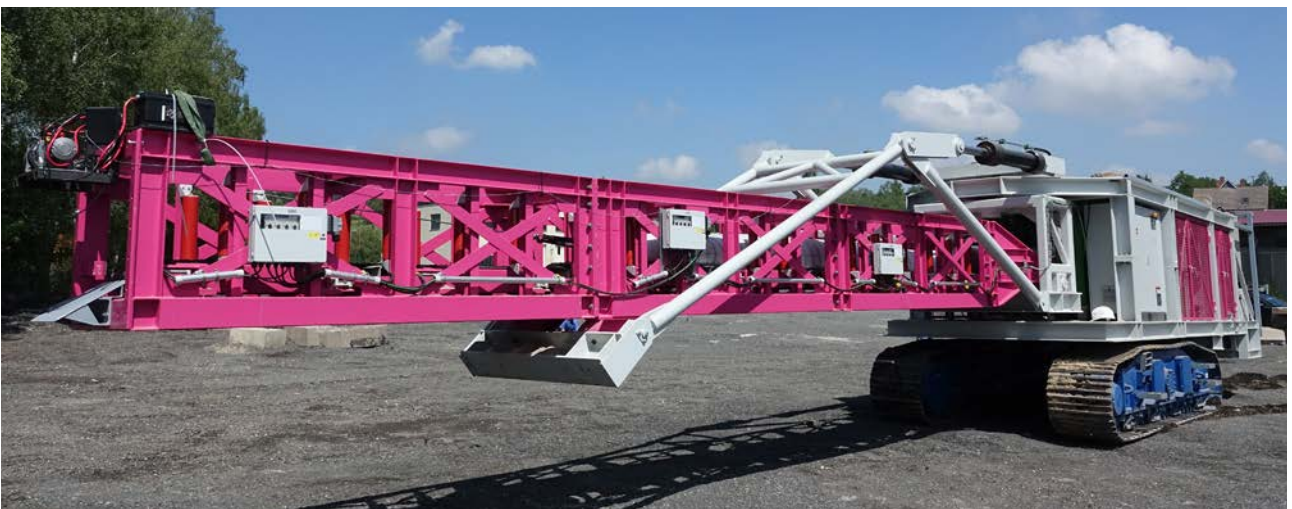
Figure 8: Tube paver (Dybatec)
