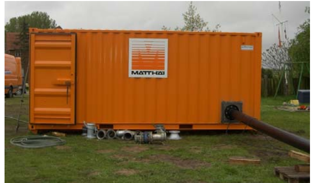
Abbildung 3.2-1 Baucontainer mit integrierter Polymeransatz- und dosierstation sowie durchgeführter Spüleleitung [HUESKER]
