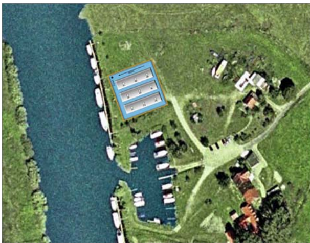
Abbildung 3.3-2 Anordnung des Entwässerungsfeldes nördlich des Sportboothafens und Platzierung der geotextilen Schläuche [MATTHÄI]
