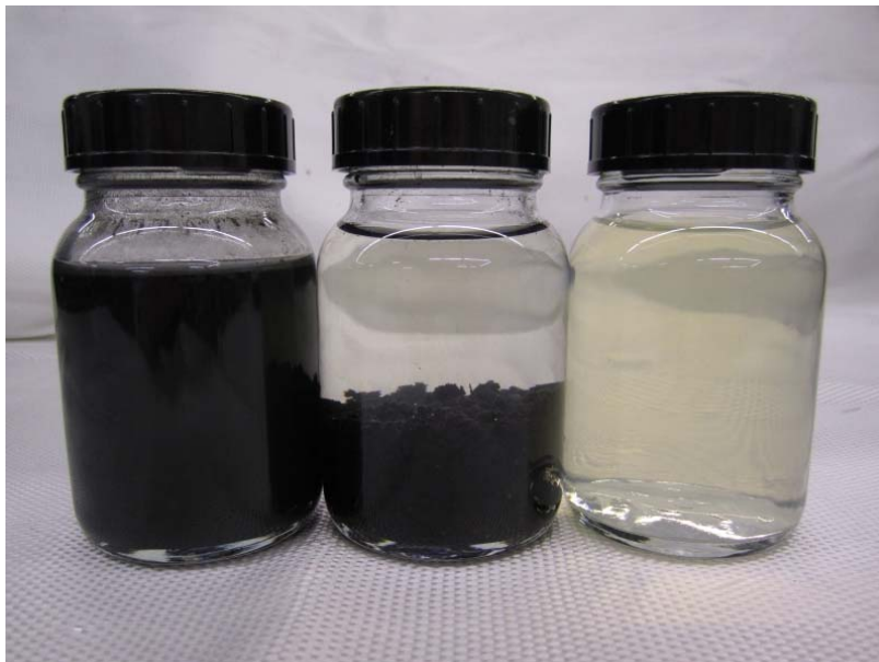
Abb. 2.1 Effekt der Zugabe von Polymeren: Schlammsuspension; Suspension nach Zugabe des Flockungshilfsmittels; Filtrat nach Verwendung eine speziellen Filtergewebes (von links nach rechts)
