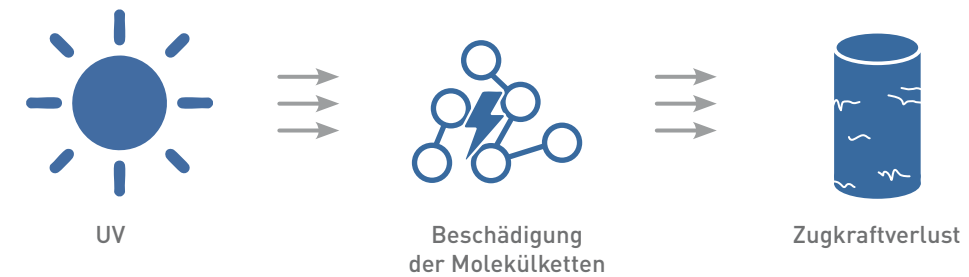
Abb. 3: Schematische Darstellung des UV-bedingten Abbauprozesses
