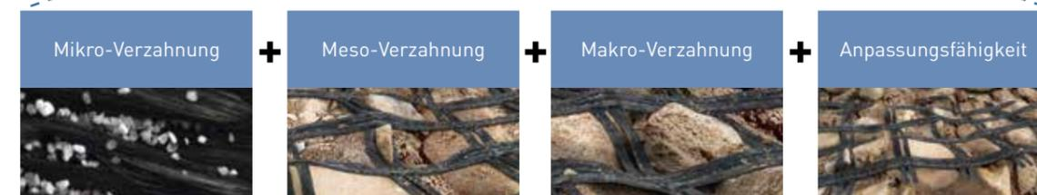
Oberflächenraue Geogitter gehen mit den Bodenpartikeln eine mikroskopische Verzahnung ein (Reibung).
