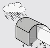
Der Lubratec Weideunterstand besitzt eine solide und einfache Bauweise. Er ist durch seine Flexibilität für verschiedenste Zwecke einsetzbar. Dreiseitige Panels bieten eine Mobilität bei der Standortwahl. Die Zaunelemente und die Dachkonstruktion bestehen aus verzinktem Rohr.
