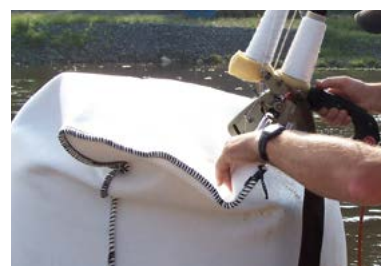
Verschluss der Säcke mittels Handnähmaschine
