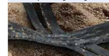
Fähigkeit des Geogitters, sich an die Unebenheiten des Bodens bei der Verdichtung anzupassen.
