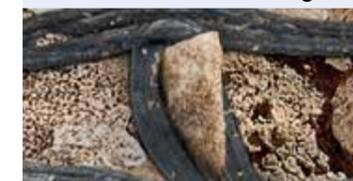
Durchdringung der Maschenöffnungen durch Steine und Kies, d.h. Verzahnung des Gesteins durch das Gitter hindurch.
