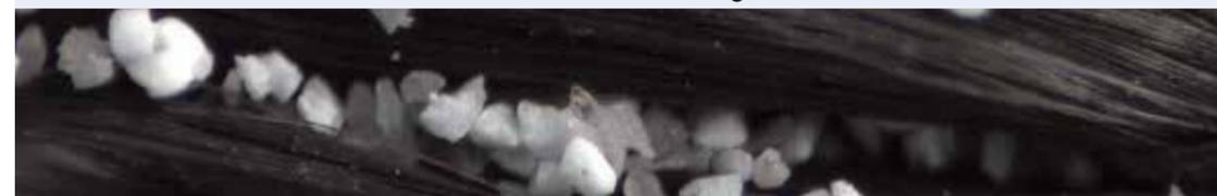
**Synonym für Reibung/Haftung:** mikroskopische Verzahnung der Bodenpartikel mit der Oberfläche des Gitters. 20-fache Vergrößerung: Raue Oberflächenstruktur von Fortrac, dargestellt mit Sandkörnern in 0,1 - 0,3 mm Größe, die sich mikroskopisch verzahnen und die Reibung erhöhen.
