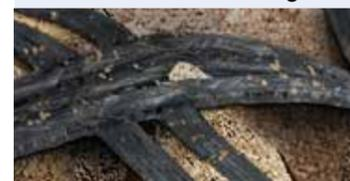
Verzahnung der Bodenpartikel mit den Materialsträngen des Geogitters aufgrund der Oberflächenstruktur.
