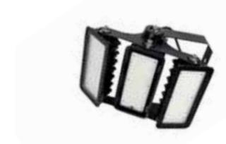
Die High-Power-LED-Chips erzeugen Licht in 5.600 K, dabei produzieren sie pro Watt 135 Lumen. Das Aluminium-Gussgehäuse mit Kühlrippen ist pulverbeschichtet lackiert. Ein robustes Flachglas, das mehrseitig sicher verschraubt ist, dichtet das Innenleben mit der Schutzklasse IP65 ab. Die Konsolen der Aufhängung sind aus Edelstahl gefertigt und sorgen für eine sichere
