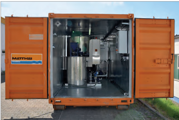
Mobile Polymeraufbereitungs und -dosieranlage
