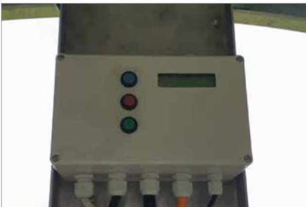
Automatische Zeitsteuerung für individuelle Fresszeiten
