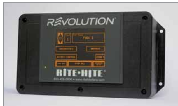
Eco-Commander mit Touchscreen für die automatische Regelung nach Temperatur oder Zeitprogramm. Regelt maximal 18 Ventilatoren in 3 Gruppen.
