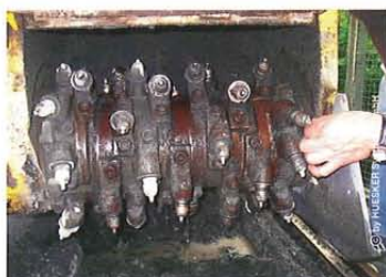
Bild 5: Nahezu keine Fasern haben sich um die Fräswalze gelegt
