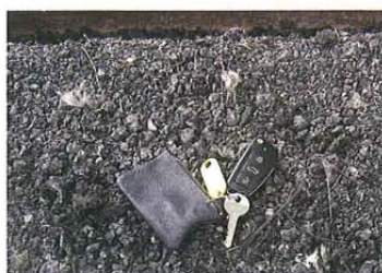
Bild 4: Nur kurze Restfasern des Gitters sind im Fräsgut zu erkennen
