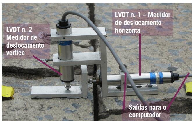
Figura 1 – Medidor de deslocamento “Crack Activity Meter” (CAM).
