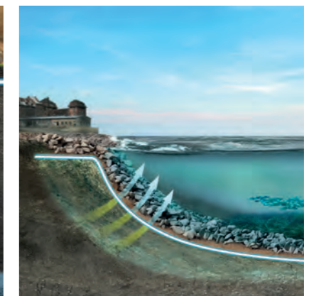
Sicherung kontaminierter Sedimente
